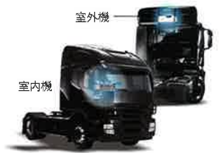
室外機(トップユニット型)取付け
